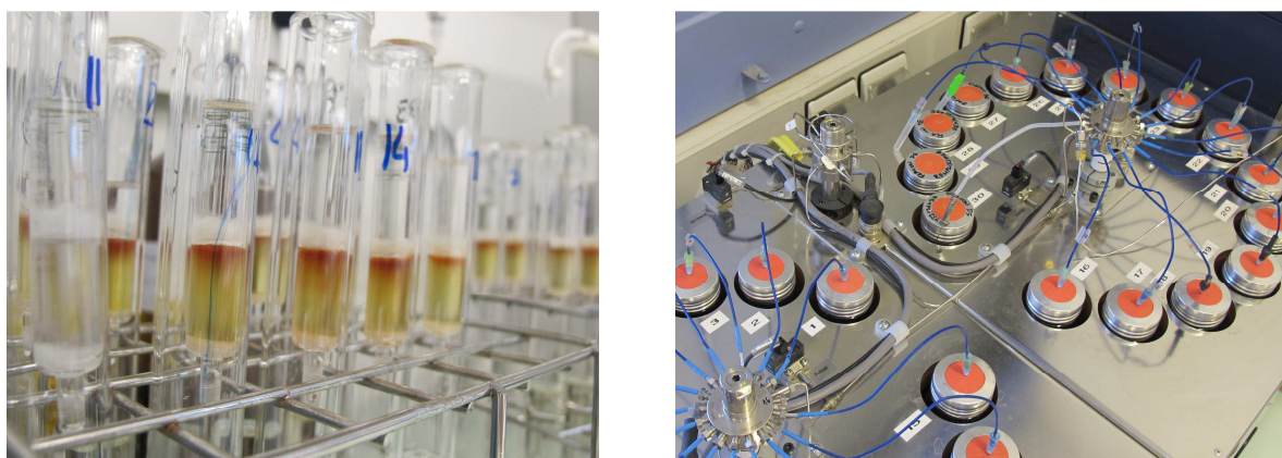
Figure 14. Photos montrant les outils d'analyse microbienne utilisés pour étudier les microorganismes des boulettes fécales et des litières. A gauche, la migration des extraits de lipides membranaires à travers des billes de silice a pour but de séparer les phospholipides des autres lipides membranaires avant leur dosage. A droite le multiplexeur permettant d'effectuer les mesures de respiration potentielle sur 30 échantillons simultanément.
