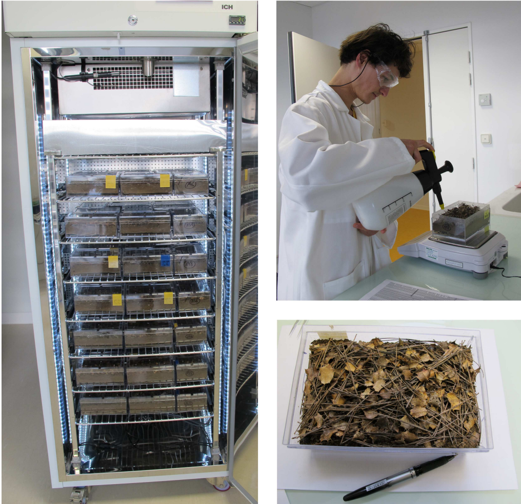
Figure 25. Photo montrant une enceinte de conditionnement (gauche), l'arrosage des microcosmes (en haut à droite) ainsi qu'un microcosme en gros plan (en bas à droite).
