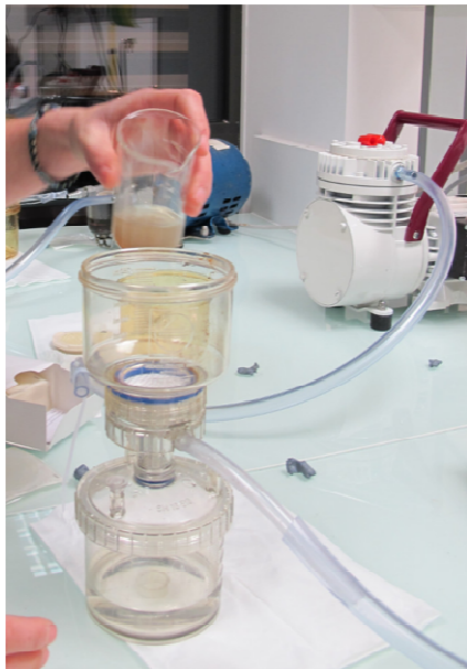
Figure 26. Photos montrant l'étape de lessivage des microcosmes. En haut la salle entièrement dédiée au lessivage et à la filtration où Jordane Gavinet est en train de travailler. En bas à gauche, une unité de filtration permettant de séparer la fraction soluble de la matière organique particulaire. En bas à droite un microcosme avec faune et un sans faune, où l'on distingue bien les boulettes fécales riches en matière organique (sombre), du sol minéral (clair).
