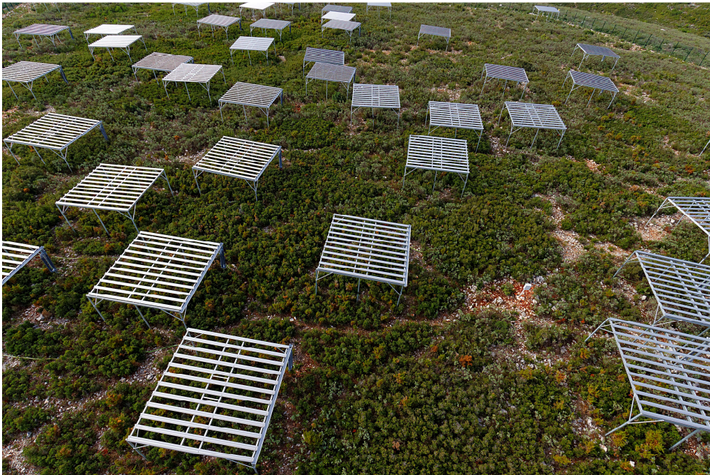
Figure 45. Photo des dispositifs d'exclusion de pluies du projet Climed.
