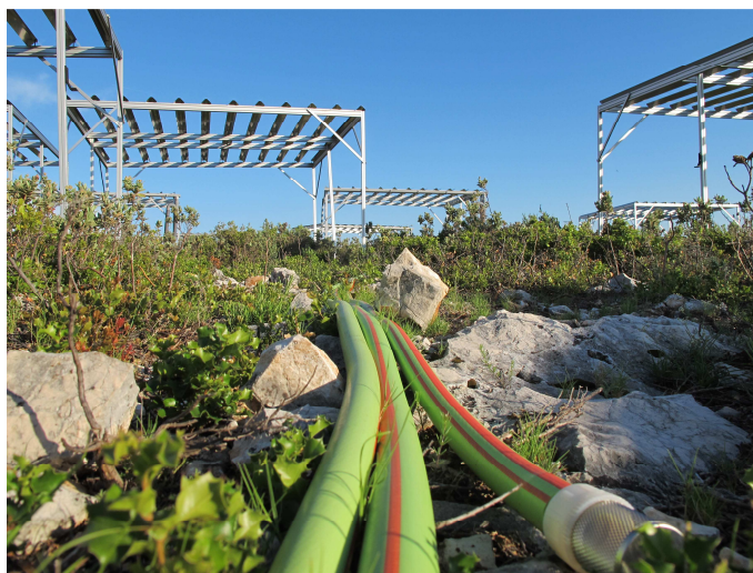
Figure 10. Photo des dispositifs d'exclusion de pluie (arrière plan) avec les tuyaux évacuant les précipitations hors des parcelles (au premier plan).
